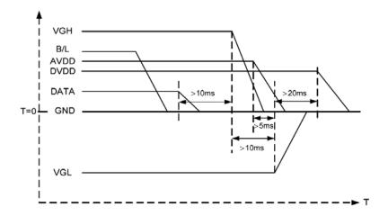
$$B/L \rightarrow Data \rightarrow V_{GH} \rightarrow V_{GL} \rightarrow V_{DD}$$
